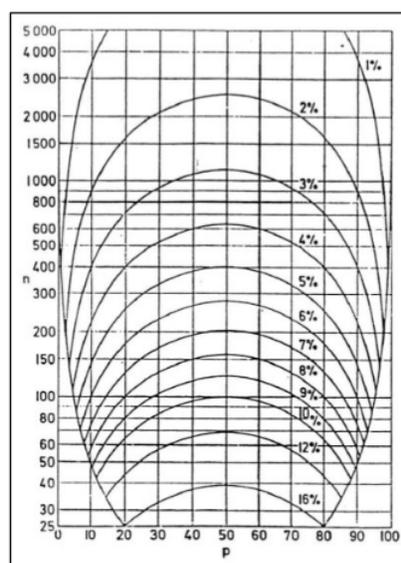
Gambar 2. Diagram Van der Plas yang digunakan untuk mencari nilai simpangan baku mineral berat. Simbol  $n$  = jumlah total mineral yang dihitung,  $p$  = persentase setiap mineral. Misalnya:  $n = 300$ ,  $p = 25\%$ , maka simpangan bakunya adalah 5%. Sehingga persentase mineral yang dihitung antara 20%-30%. Dalam hal ini nilai  $p$  + simpangan baku yang diambil, sehingga  $p$  terkoreksi 30% (Rohendi dan Aryanto, 2016; Setyanto dan Surachman, 2017)
