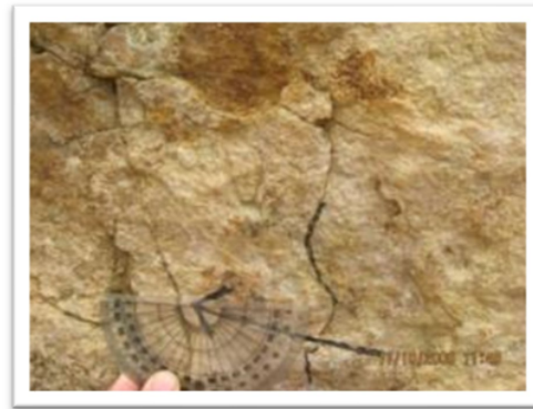
Gambar-6. Gambar goresgaris bidang sesar geser kiri N130°E/82°SW pitch 20 SE (pandangan kearah NE) pada sesar Bojanegara 2 di daerah Wadas
