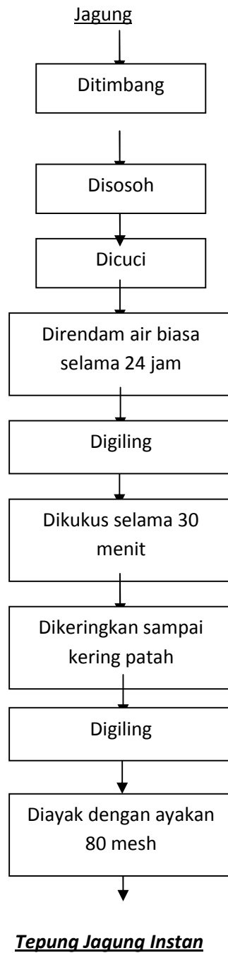
Lampiran 1. Diagram alir pembuatan tepung jagung instan (Aini, 2009)
