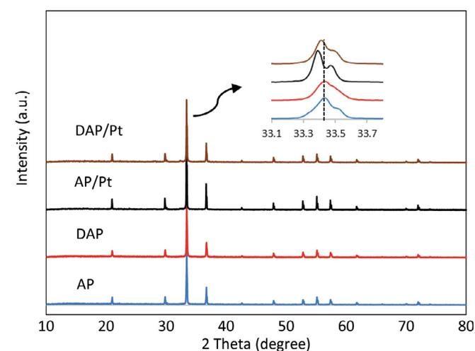
Fig. 1. The XRD pattern of  $\text{Ag}_3\text{PO}_4$  (AP), defect- $\text{Ag}_3\text{PO}_4$  (DAP),  $\text{Ag}_3\text{PO}_4/\text{PtCl}_6^{2-}$  (AP/Pt), and defect- $\text{Ag}_3\text{PO}_4/\text{PtCl}_6^{2-}$  (DAP/Pt).
