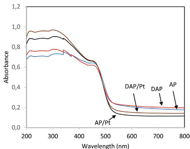
Fig. 2. The absorption of  $\text{Ag}_3\text{PO}_4$  (AP), defect- $\text{Ag}_3\text{PO}_4$  (DAP),  $\text{Ag}_3\text{PO}_4/\text{PtCl}_6^{2-}$  (AP/Pt), and defect- $\text{Ag}_3\text{PO}_4/\text{PtCl}_6^{2-}$  (DAP/Pt).
