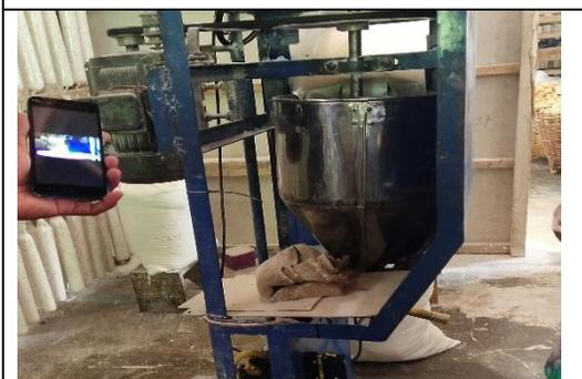
Gambar 5. Mesin Baglok pembuat tempe
