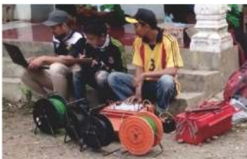
Gambar 4. Peralatan resistivitymeter merk Naniura dan komponen pendukungnya.
