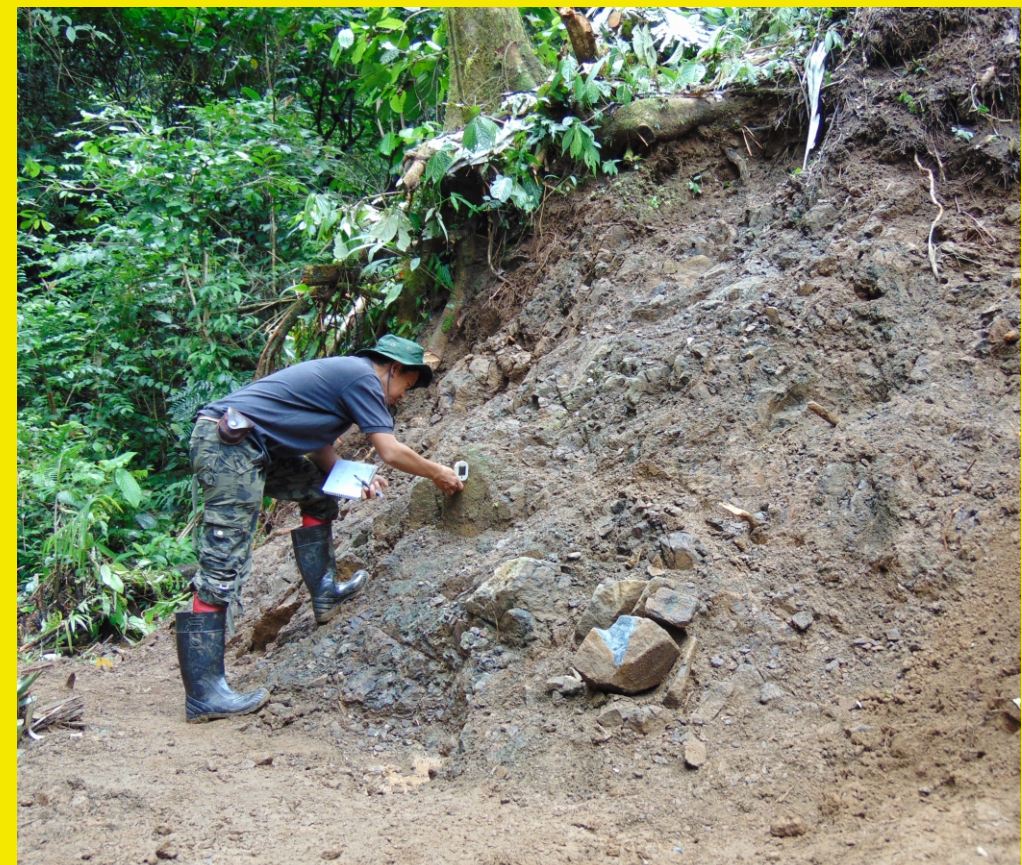
Pengamatan frakturasi pada zona mineralisasi U-Th-LTJ di Sektor Hulu Mamuju, Sulawesi Barat Kontributor Foto: Frederikus Dian Indrastomo
