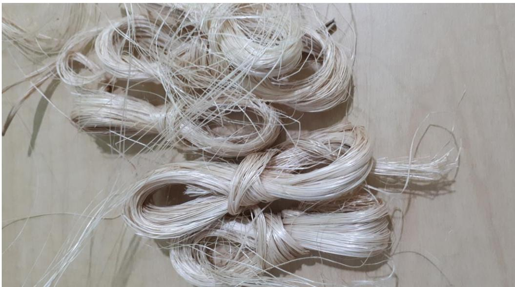
**Gambar 3.** Hasil serat abaka dari Talaud yang telah diekstraksi menggunakan dekortikator dan dikeringkan
