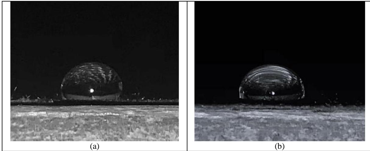
**Gambar 2.** Permukaan kain kapas bersifat hidrofobik (a) sebelum dilakukan pencucian (b) sesudah dilakukan pencucian
