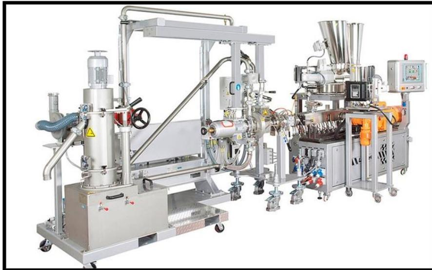
**Gambar 6.** Mesin pembuatan *chips* polimer ([www.leistritz.com](http://www.leistritz.com))
