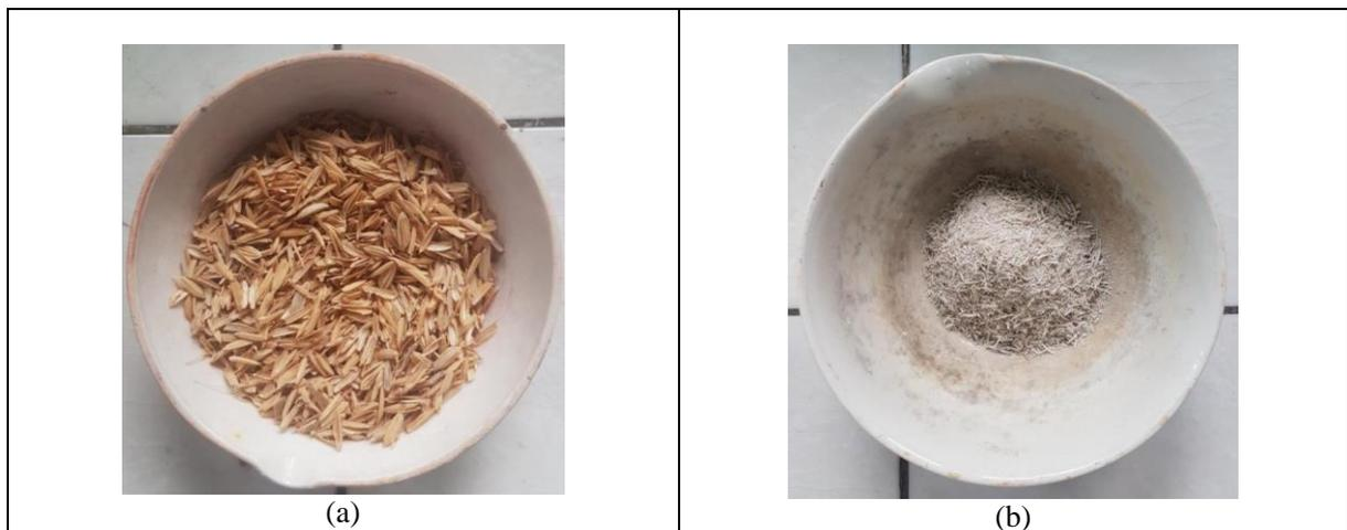
**Gambar 1.** (a) Sekam padi setelah proses leaching dan pencucian (b) Sekam padi yang telah dibakar pada suhu 700°C
