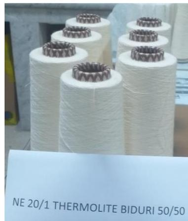
**Gambar 8.** Salah satu *prototype* benang campuran dari serat biduri
