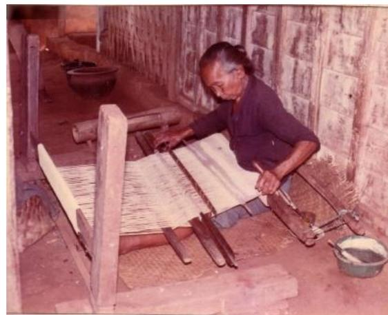
**Gambar 4.** Menenun dengan alat tenun Gedhog
