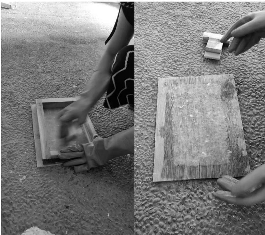
**Gambar 3 .** Proses pencetakan serat pada papan kayu
