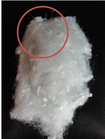
**Gambar 1.** Poliester *staple fiber* dengan cacat
