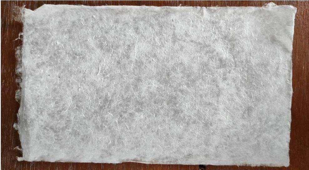
**Gambar 7.** Kertas serat daun nanas yang dilumatkan dengan soda *ash* (tipis)
