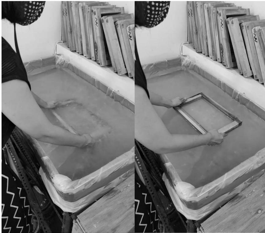
**Gambar 2 .** Proses penyaringan serat dengan *screen*
