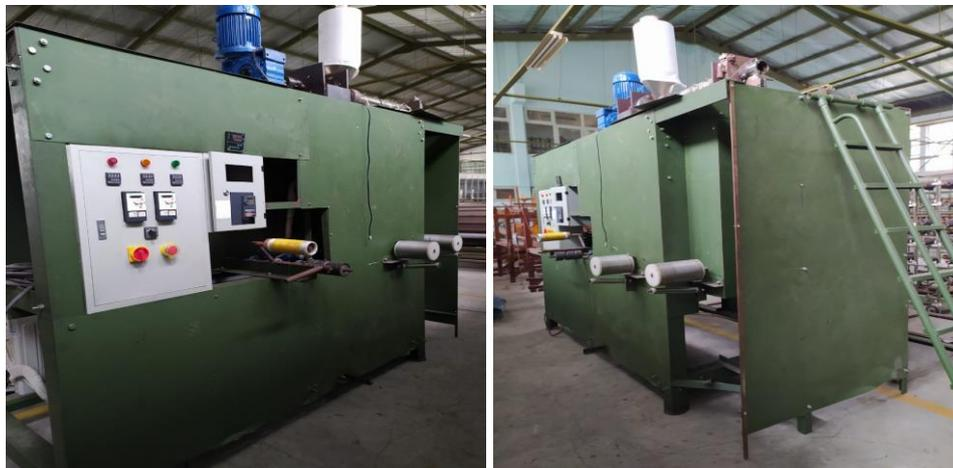
**Gambar 3.** Mesin pemintalan leleh skala laboratorium tampak depan dan samping
