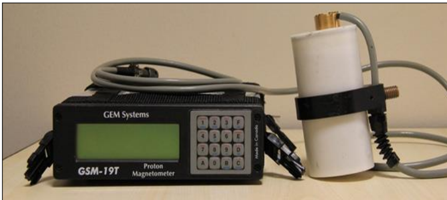
Gambar 3.1. Peralatan utama penelitian yang digunakan dalam akuisisi data magnetik; Proton Precession Magnetometers (PPM) tipe GSM-19T.
