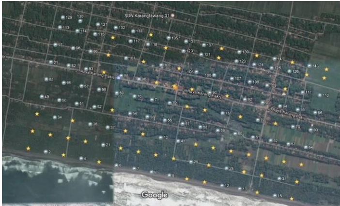
Gambar 3.3. Plotting titik-titik ukur untuk akuisisi data magnetik di kawasan prospek bijih besi Pesisir Nusawungu Barat Kabupaten Cilacap.
