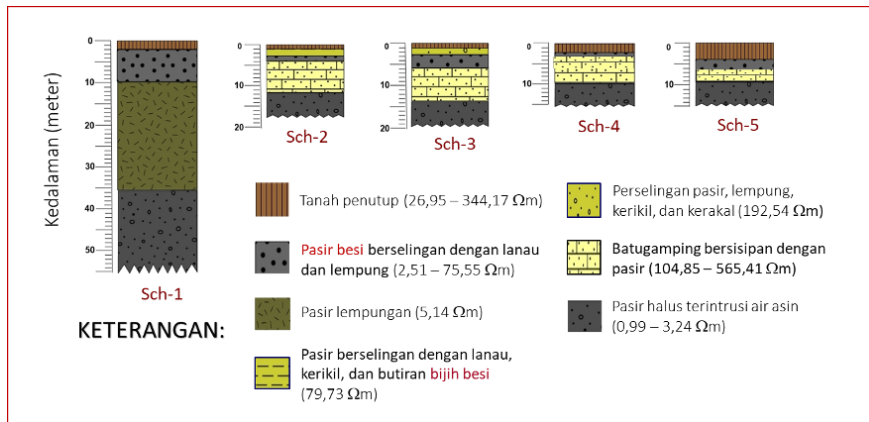
Gambar 4.21. Log resistivitas batuan yang telah diinterpretasi secara litologi di kawasan Pesisir Nusawungu Timur Kabupaten Cilacap (Sehah dkk., 2019).
