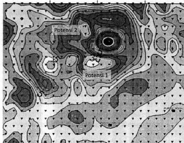
Gambar 4. Peta gravitasi residual yang menunjukkan potensi sumber panas untuk sistem panas bumi di lereng bagian selatan dan lereng barat laut.
