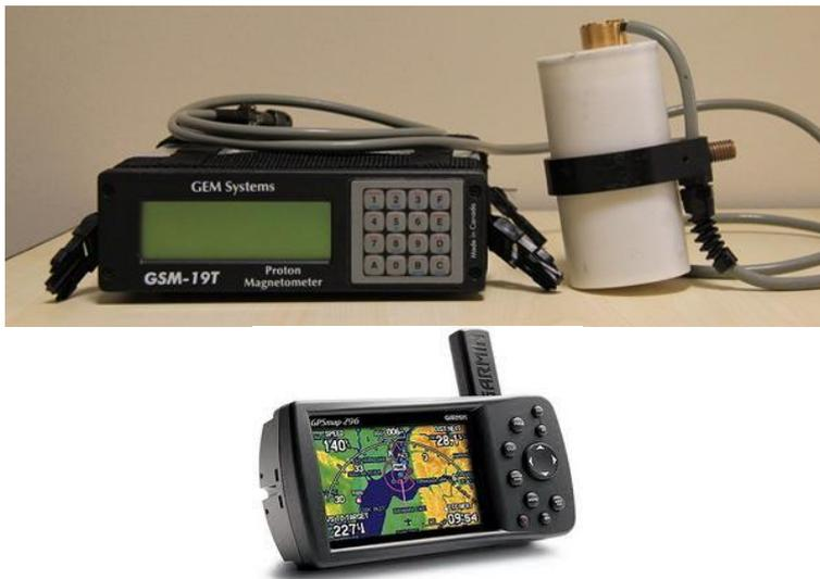
**Gambar 4.** Peralatan Utama yang Digunakan dalam Akuisisi Data Magnetik; *Proton Precession Magnetometers* (PPM) tipe GSM-19T dari GEM System dan *Global Positioning System* (GPS) merk Garmin.
