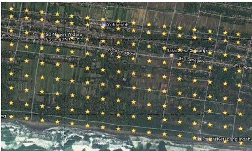
**Gambar 6.** Desain Survei Magnetik Salah Satu Kawasan di Pesisir Kecamatan Binangun Kabupaten Cilacap; Akuisisi Data Dilakukan Sesuai Titik-Titik Lokasi yang Telah Ditentukan Menggunakan Aplikasi *Google Earth*.
