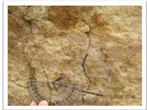
Gambar-6. Gambar goresgaris bidang sesar geser kiri N130°E/82°SW pitch 20°SE (pandangan kearah NE) pada sesar Bojanegara 2 di daerah Wadas
