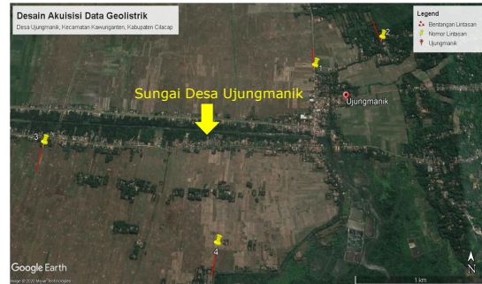
Gambar 4. Desain akuisisi data geolistrik konfigurasi Wenner di Desa Ujungmanik Kecamatan Kawunganten Kabupaten Cilacap
