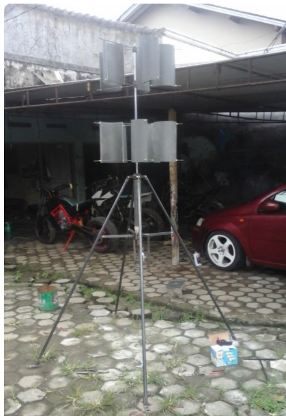
Gambar 3. Prototipe kincir angin sumbu vertikal savonius tipe-U
