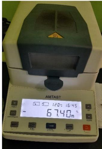
Gambar 5. Pengujian Kadar Air Menggunakan *Moisture Analyzer*
