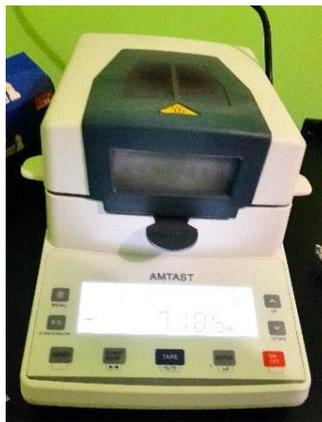
Gambar 29. Pengujian Kadar Air Menggunakan *Moisture Analyzer*
