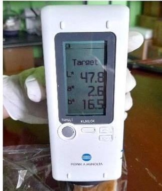
Gambar 36. Pengujian Warna Menggunakan Color Reader
