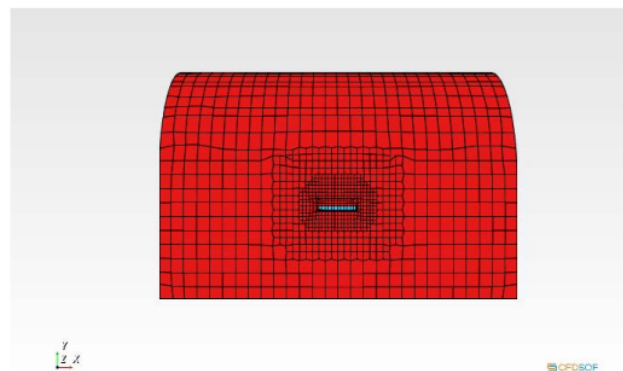
Gambar 6. Hasil grid domain (tampak sisi kiri).
