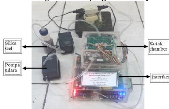
Gambar 2. Alat ukur aroma dan volatil berbasis sensor gas
