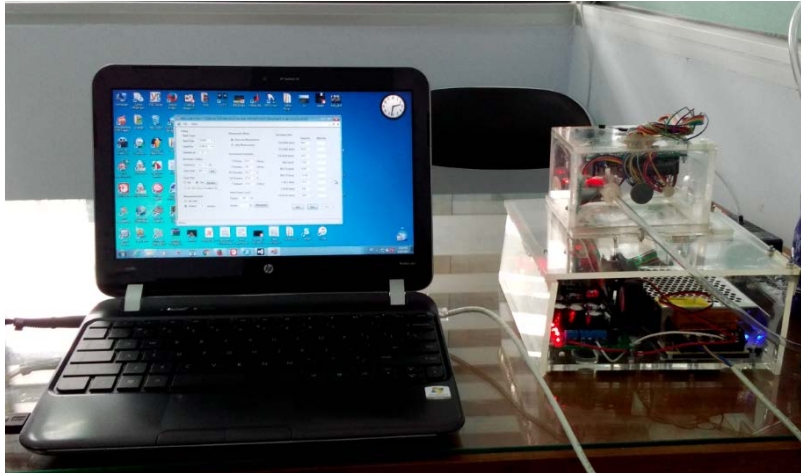
Gambar 5.1. Sistem pengukuran volatil Minyak Nilam.
