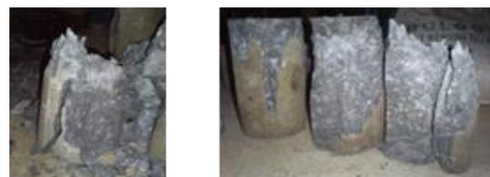
Gambar 2. Pola kehancuran benda uji
