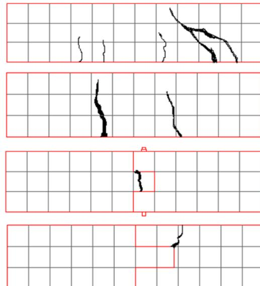
Gambar 3. Pola retak balok
