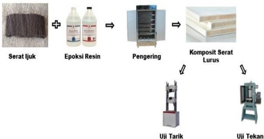
**Gambar 1.** Diagram Alir Pembuatan Komposit
